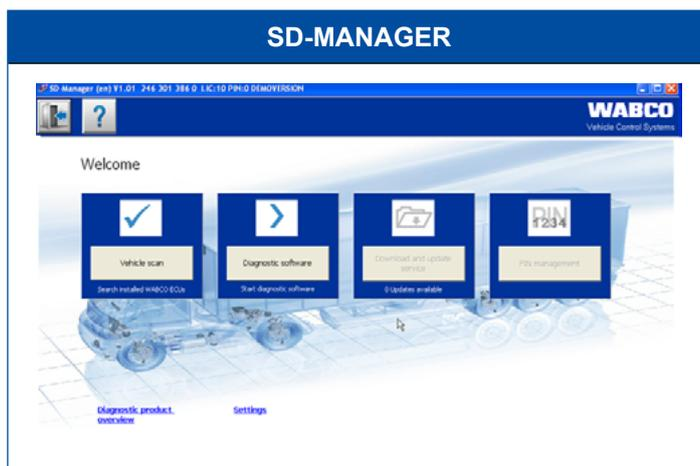
После непродолжительного сканирования можно получить полное представление о найденных в ТС блоках управления и дать первичную оценку их работоспособности. Если в диагностической памяти сохранены определенные события, то они отображаются для всех блоков управления. Затем одним нажатием кнопки можно сразу запустить диагностическое ПО.
